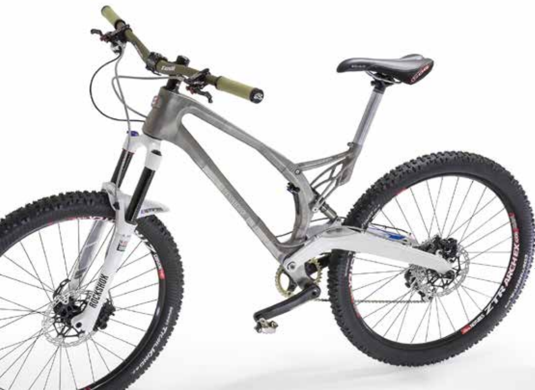
Complete fiets met frame en zadelpen 3D geprint van titaniumlegering.
