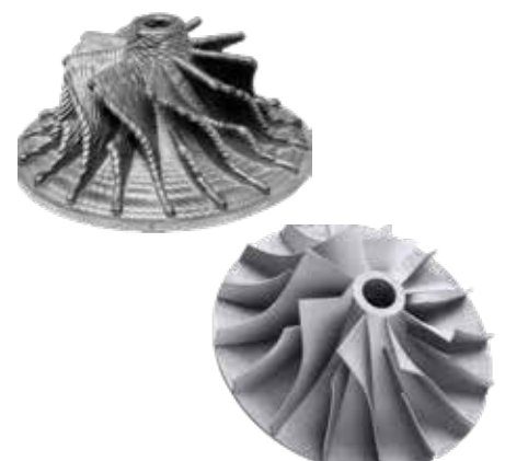
Figuur 2 Pomp impeller, links vervaardigd met WAAM (7) en rechts vervaardigd met L-PBF (8)
