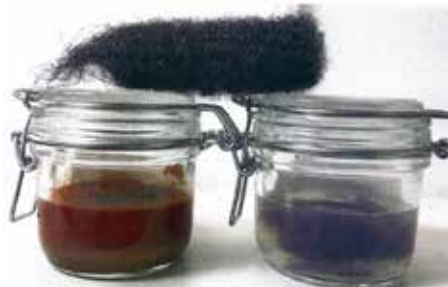
Corrosie van behandeld en onbehandeld stuk staalwol in water
