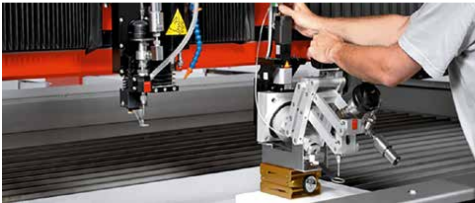
Het wisselen van de 2D en 3D snijkop kan eenvoudig door de klant zelf gebeuren. (FOTO: BYSTRONIC)
