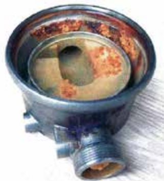
Foto 1: Tubercules in het voetstuk van een pomp
