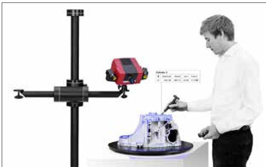
Multifunctionele sensoren combineren optische metingen met metingen via een touch probe. Zo brengt GOM de voordelen van optische en tactiele metingen samen.
