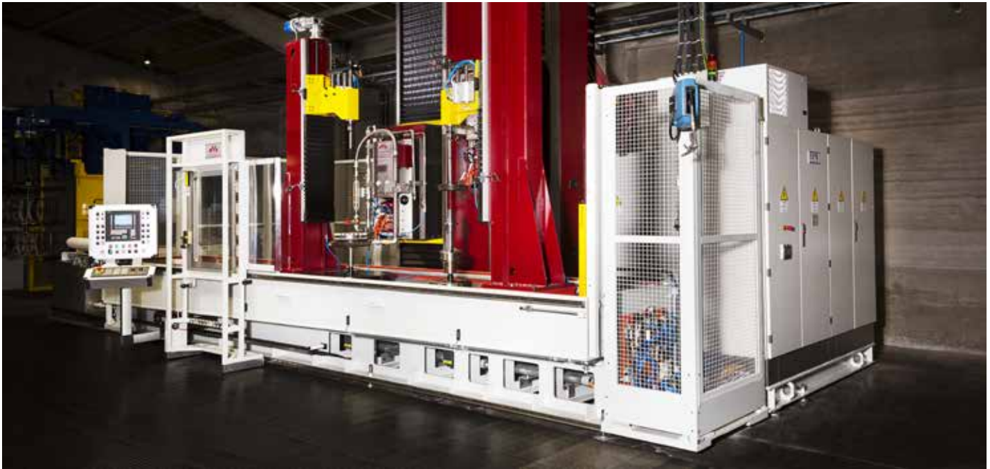
Deze nieuwe inductiehardingsmachine zorgt voor een grote meerwaarde: de omsteltijden zijn drastisch verminderd en de machine heeft veel meer mogelijkheden. Ze bestaat uit drie werkstations, twee hardingskoppen en heeft negen CNC-gestuurde assen.
