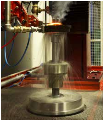
Bij inductieharding blijven maat- en vormveranderingen beperkt.
