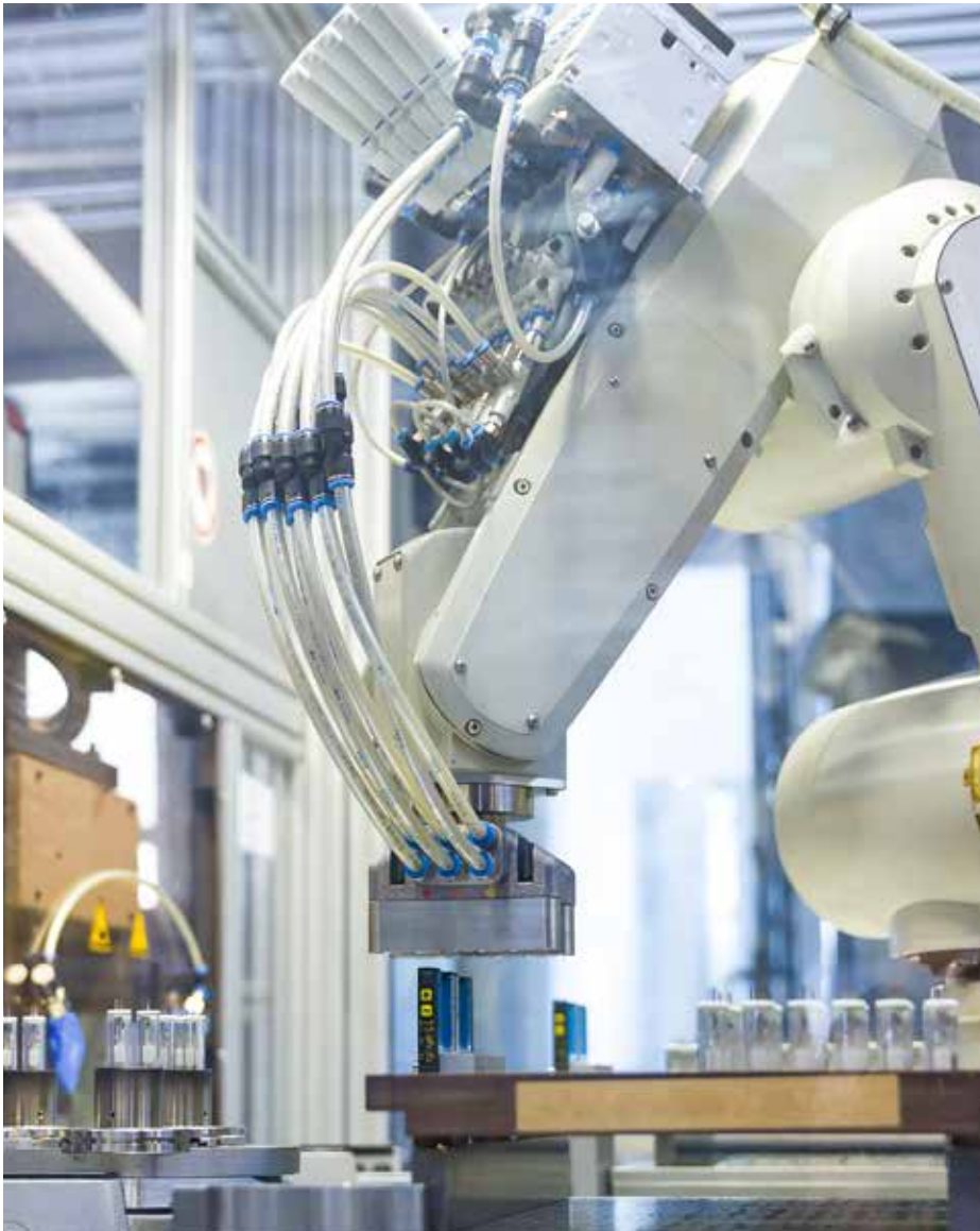
De 3D-metaalgeprinte zuiggrijper is operationeel bij Philips Lighting.
