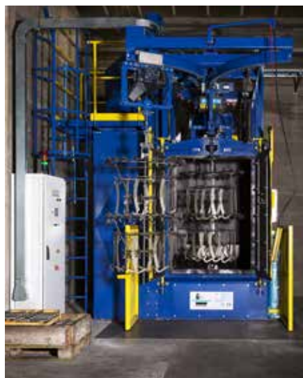
De staalstraalmachine reinigt harde stukken door middel van werpstralen met halfharde staalkorrels.
